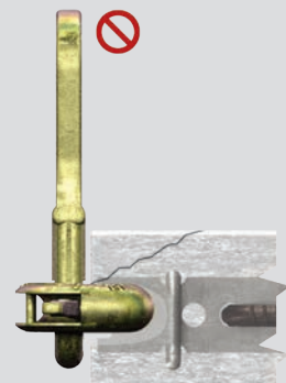
El hormigón está cubriendo la espiga del anclaje de instalación, lo que puede causar una grieta de corte.
