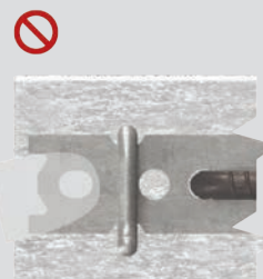
El hormigón está cubriendo la espiga del anclaje de instalación, lo que puede causar una grieta de corte.
